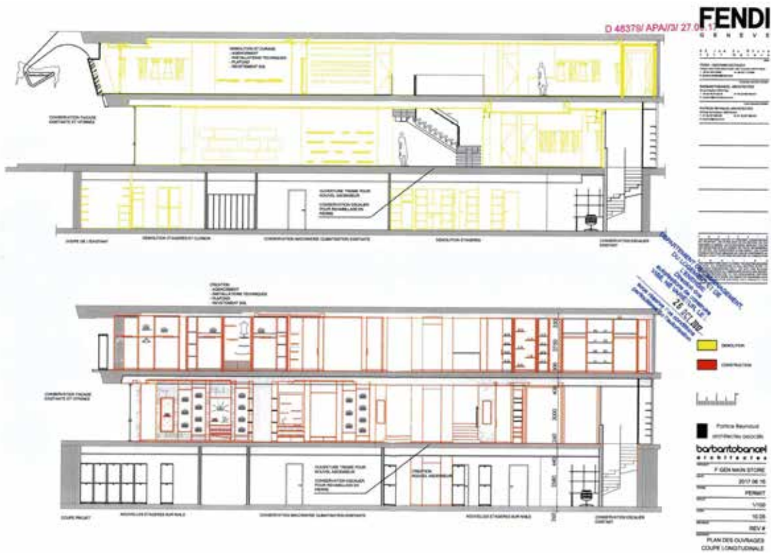
Projet de rénovation de la boutique Fendi (APA 48379), coupe transversale sur les trois niveaux de commerce (état existant et état projeté), 16 juin 2017 (archives du DT).
